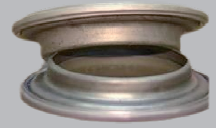
COJINETE DE AMORTIGUADOR DESGASTADO NORMA PRIMERA CALIDAD
