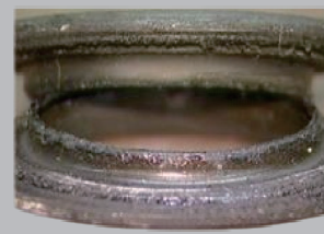
COJINETE DE AMORTIGUADOR DESGASTADO CALIDAD INFERIOR
