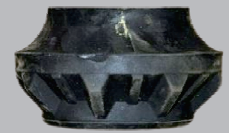
CAUCHO DESGASTADO NORMAL DEL AMORTIGUADOR SUPERIOR PRIMERA CALIDAD
